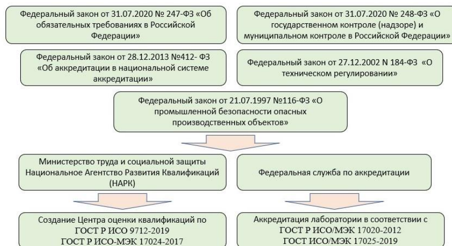
Рис.2 - Система нормативного регулирования в области неразрушающего контроля опасных производственных объектов, прогнозируемая после 01.01.2021
