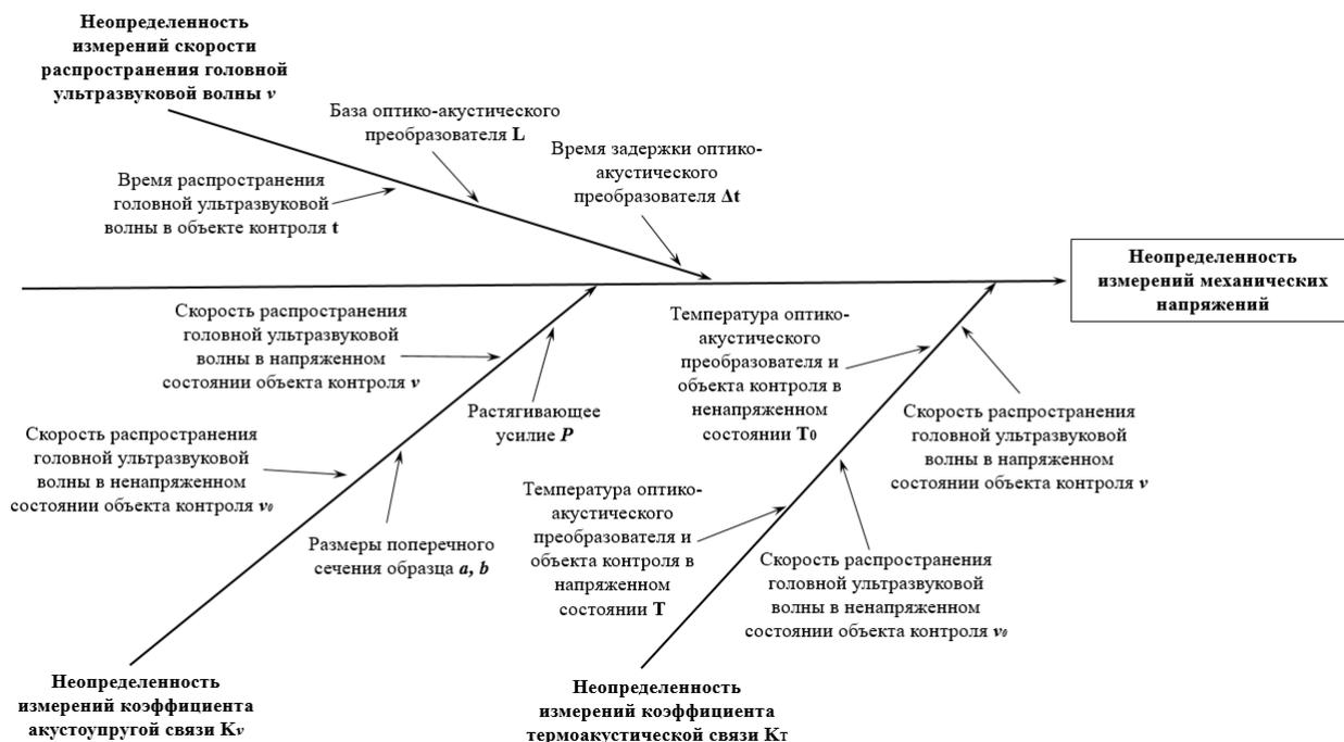
Рисунок 1 – Расширенная диаграмма Исикавы вкладов в неопределенность измерений МН
