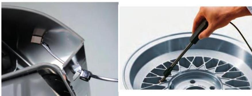
Рисунок 1. Примеры измерения толщины покрытия в труднодоступных местах: внутренняя часть корпуса (а) и автомобильного диска (б)
